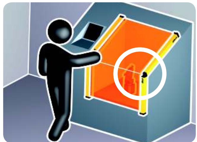
A resolução é mantida (até 40 mm) na junção entre 2 áreas protegidas
