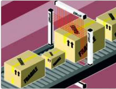
Deteção bi-dimensional de objetos em trânsito em sistema transportador usando 2 cortinas de luz. O volume pode ser calculado usando a terceira cortina de horizontal ou considerando a velocidade de deslocamento.
