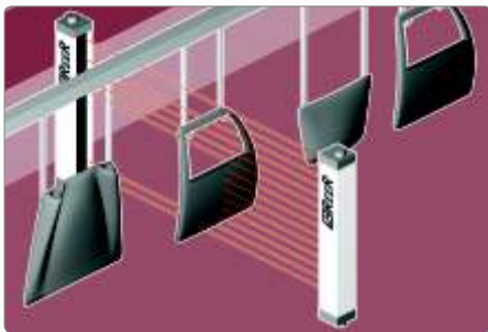
Deteção da posição e contorno de peças de trabalho em sistemas de pintura automatizados.
